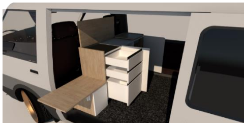
ภาพที่ 4.25 แบบร่างชุดครัวสำเร็จรูปสำหรับรถบ้านเคลื่อนที่ แบบที่ 3
