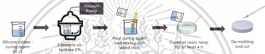
รูปที่ 3.3 การเตรียมชิ้นงานยางซิลิโคนที่มีลักษณะพื้นผิวแบบเรียบ
