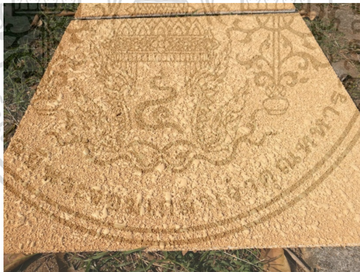
ภาพที่ ง.6 ทำการพ่นไปที่ชิ้นงานให้สม่ำเสมอและมีชั้นความหนาตามต้องการ ภาพโดย : สหพรณ อารณ (2565)
