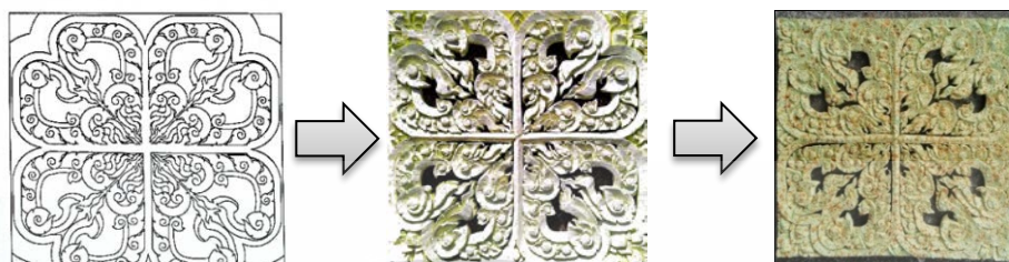
ภาพที่ 4.30 ภาพแสดงต้นแบบผลิตภัณฑ์ตกแต่งภายในด้วยเทคโนโลยีการพันทรายขนาด 60x60 cm.
