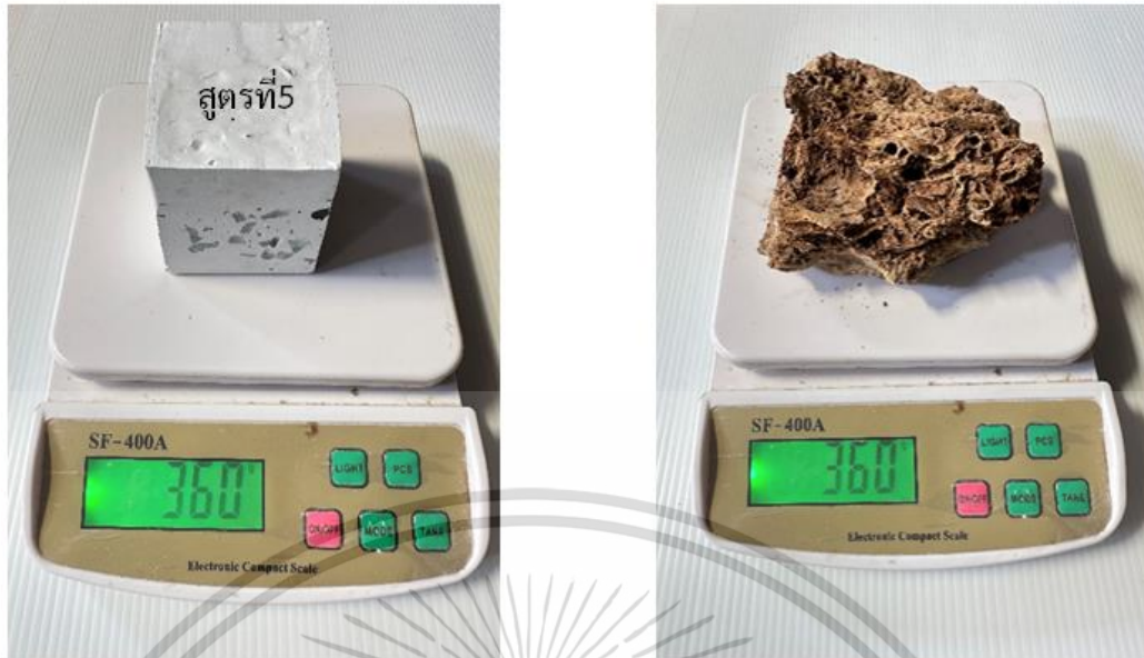
ภาพที่ ง.13 การทดสอบชั่งน้ำหนักระหว่างวัสดุจากเศษกระจกกับแก้วรูปุน ภาพโดย : ศุภานัน คมสัน(2565)
