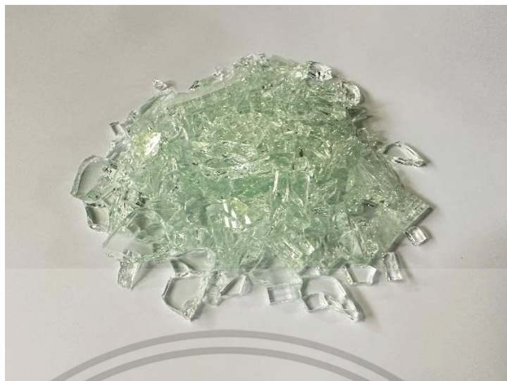
ภาพที่ ง.5 นำเศษกระจกที่แตกเป็นเม็ดข้าวโพดที่มีขนาดไม่เกิน 2 เซ็นติเมตร
