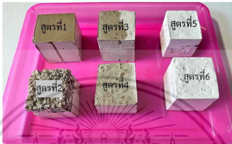
ภาพที่ 4.8 แสดงกระบวนการทดลองการดูดซับน้ำวัสดุจากเศษกระจก ที่มา : ศุภานัน คมสัน (2565)
