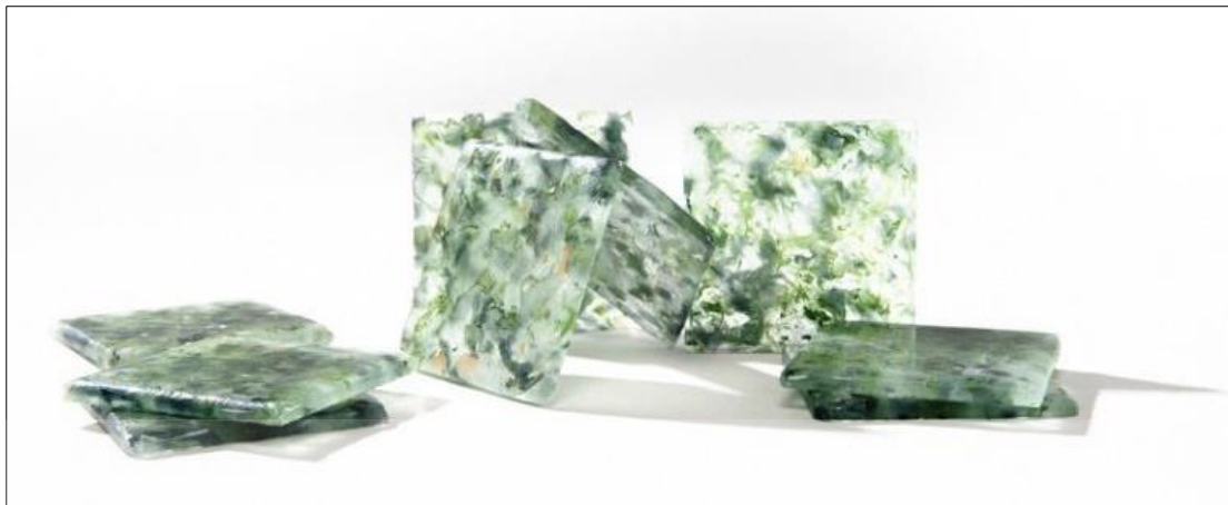
ภาพที่ 4.4 กระจกเบื้องแก้วรีไซเคิลที่ทำมาจากเศษแก้ว และขยะอิเล็กทรอนิกส์
