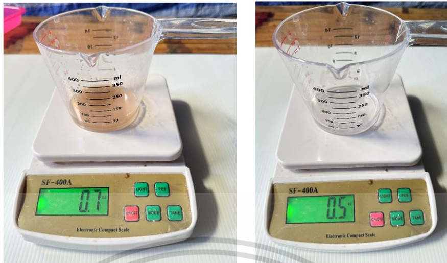
ภาพที่ ง.15 ปริมาณน้ำที่เหลือจากผลทดลองการดูดซึมน้ำระหว่างวัสดุจากเศษกระจก กับแก้วรูปวง
