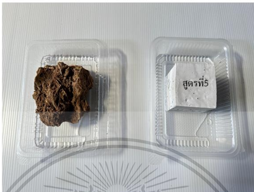
ภาพที่ 4.10 การทดลองดูดซับน้ำระหว่างวัสดุจากเศษกระจกกับหินรูพรุน ที่มา : ศุภานัน คมสัน (2565)
