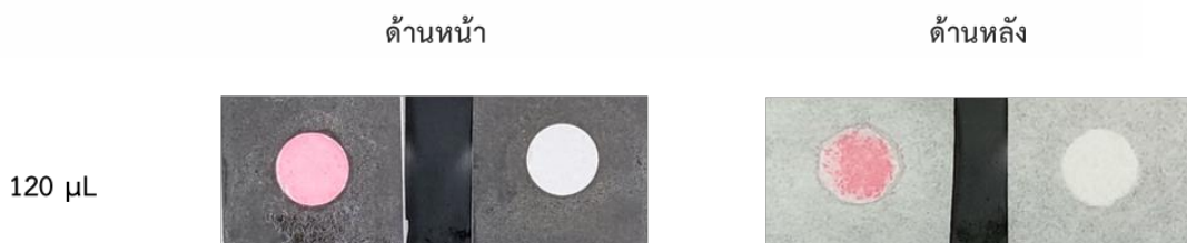
รูปที่ 4.19 แสดงภาพถ่าย Double-layered PAD ที่ใช้กาวสองหน้าแบบหนาแปะ 3 ชั้น โดยหยด Bphen ลงด้านบนแล้วหยดสารมาตรฐาน Fe(II) 2 มิลลิกรัมต่อลิตรที่ปริมาตร 120 ไมโครลิตร
