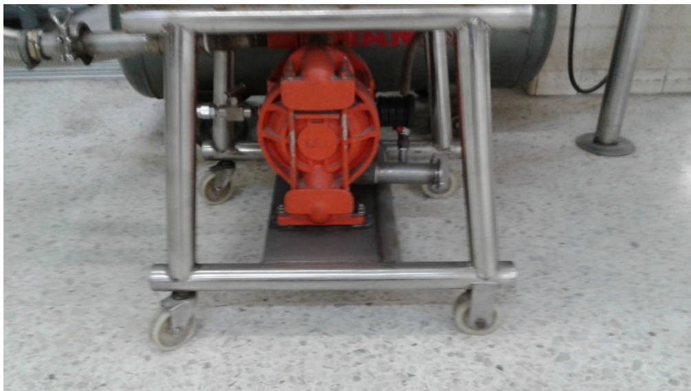
รูปที่ 3.6 ปัมป์ไดอะแฟรมสำหรับเครื่องกรองแบบอัดชนิดแผ่นอัดและกรอบ
