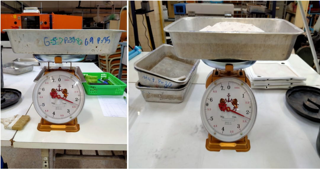
รูปที่ 3.2 เครื่องชั่งและการชั่งเพื่อเตรียมวัสดุตัวอย่างสำหรับการทดลองศึกษาการกรอง
