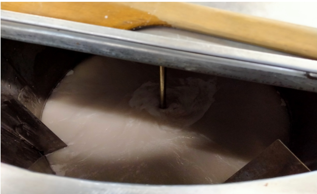
รูปที่ 3.3 การกวนผสมวัสดุตัวอย่างกับน้ำภายในถังสำหรับผสมสำหรับการทดลองศึกษาการกรอง
