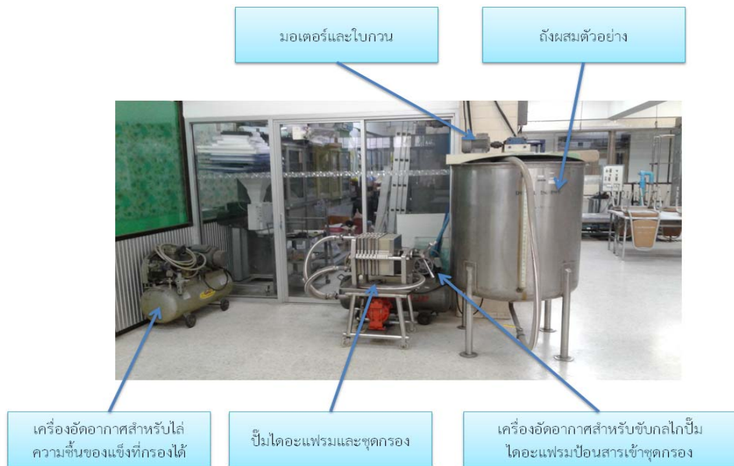
รูปที่ 3.4 ชุดทดลองการกรองแบบอัดชนิดแผ่นอัดและกรอบ
