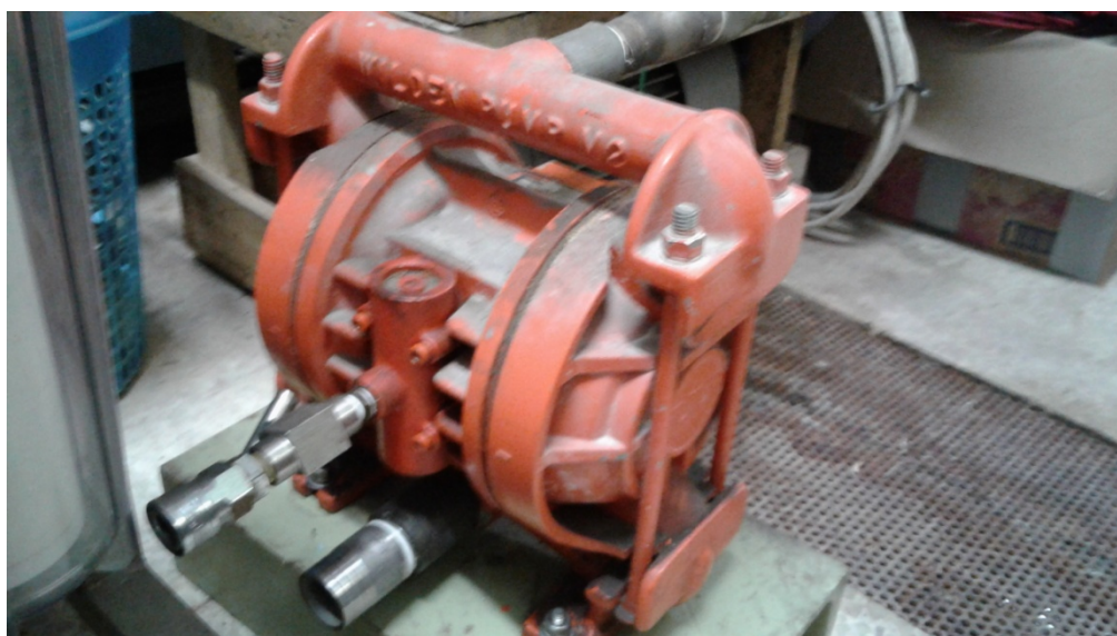
รูปที่ 3.7 ปัมป์ไดอะแฟรมสำหรับเครื่องกรองแบบอัดชนิดแผ่นอัดและกรอบ ยี่ห้อ WILDEN PUMP รุ่นของปัมป์ M2
