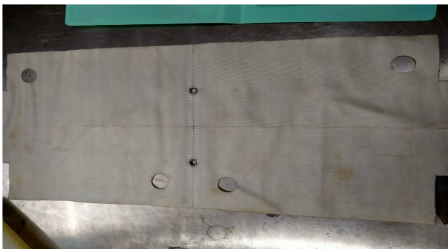
รูปที่ 4.1 ลักษณะผ้ากรองของเครื่องกรองแรงดันชนิดแผ่นอัดและกรอบ
