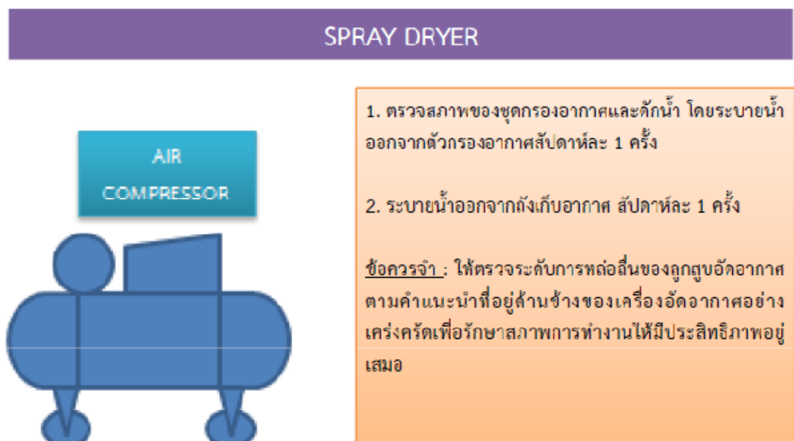
ภาพที่ 4.55 แผนภาพแสดงแนวทางสำหรับการซ่อมบำรุงของชุดปฏิบัติการทดลอง Spray Dryer (เฉพาะเครื่องอัดอากาศ)
