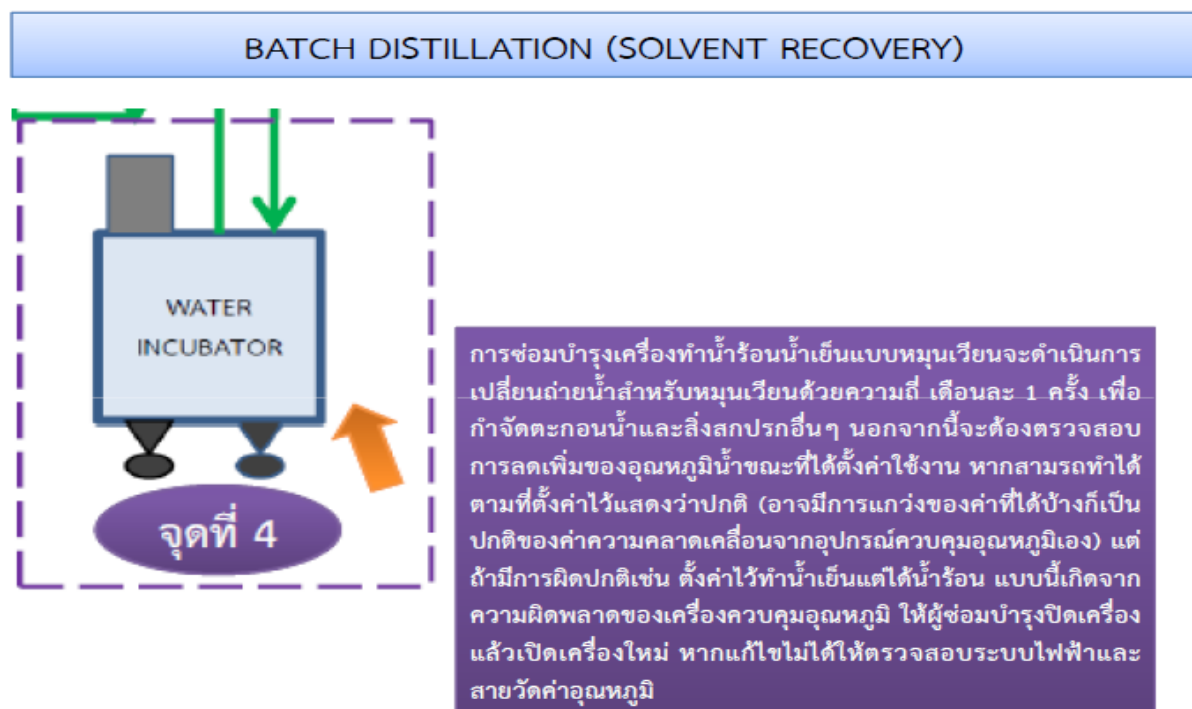
ภาพที่ 4.43 แผนภาพแสดงแนวทางสำหรับการซ่อมบำรุงของชุดปฏิบัติการทดลอง Batch Distillation (เฉพาะเครื่องทำน้ำร้อนน้ำเย็นแบบหมุนเวียน)
