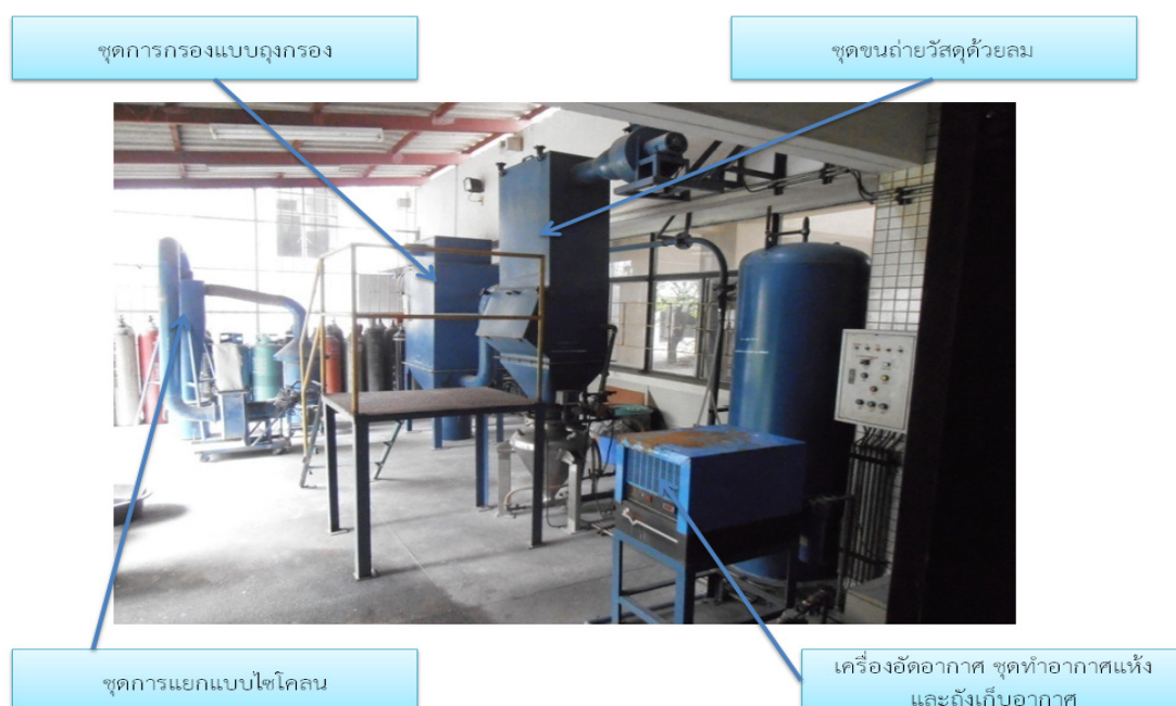
ภาพที่ 3.22 ส่วนประกอบของชุดฝึกปฏิบัติการทดลอง Pneumatic Conveyor and Bag Filter
