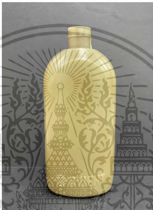
รูปที่ 4.12 ชิ้นงานที่ได้จากการขึ้นรูปจากเทคนิค Extrusion blow molding
