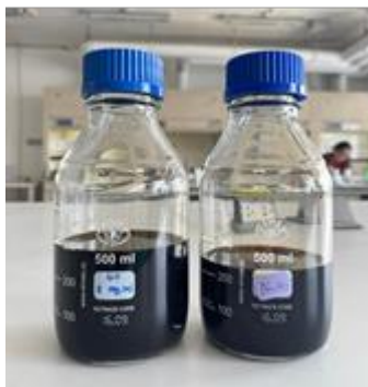
รูปที่ 2.3 สารแขวนลอยกราฟีนออกไซด์ และนาโนกราฟีนออกไซด์
