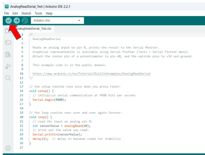
รูปที่ 2.23 วิธีการเลือกแปลไฟล์โปรแกรมที่ใช้งาน
