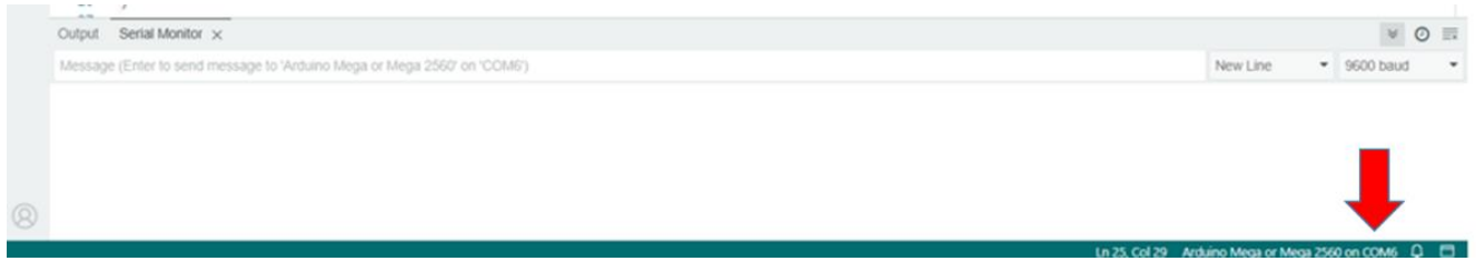
รูปที่ 2.22 ผลลัพธ์เมื่อเลือกบอร์ดและพอร์ตบนเมนูหน้าต่างโปรแกรม
