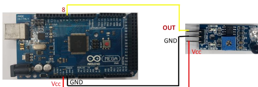
รูปที่ 4.10 การติดตั้งสายระหว่างบอร์ด Arduino กับเซ็นเซอร์อินฟราเรด
