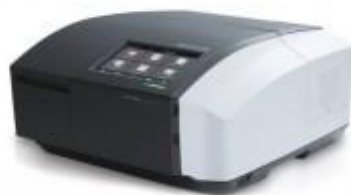
รูปที่ 2.19 เครื่องยูวี-วิสิเบิลสเปคโตรโฟโตมิเตอร์ (UV-visible Spectrophotometer) [21] เอกสารนี้เป็นเอกสารที่สงวนลิขสิทธิ์ การใช้งานเพื่อการตีพิมพ์ต่าง ๆ ไม่ขอสงวนสิทธิ์ในค่าใช้จ่ายในการดำเนินการ ไม่ว่าจะกรณีใดๆ ทั้งสิ้น อีกทั้งห้ามมิให้คัดลอกเนื้อหาและต้องอ้างอิงถึงเจ้าของเอกสารทุกครั้งที่มีการนำไปใช้
