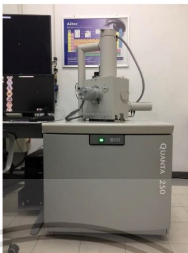
รูปที่ 3.3 กล้องจุลทรรศน์อิเล็กตรอนแบบส่องกราด (Scanning Electron Microscope, SEM)
