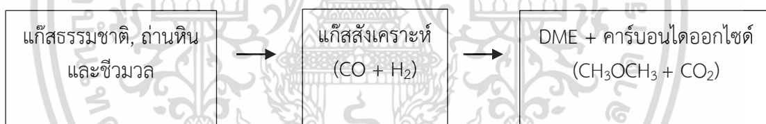
รูปที่ 2.5 กระบวนการผลิตไดเมทิลอีเทอร์แบบทางตรง (Direct DME Synthesis) [5]
