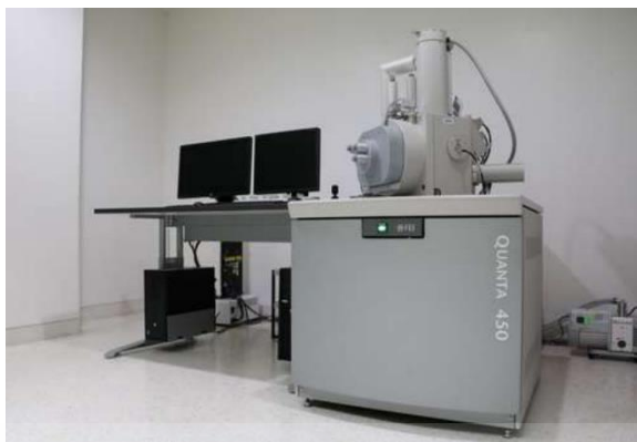
รูปที่ 2.25 เครื่อง Scanning Electron Microscope, SEM [41]
