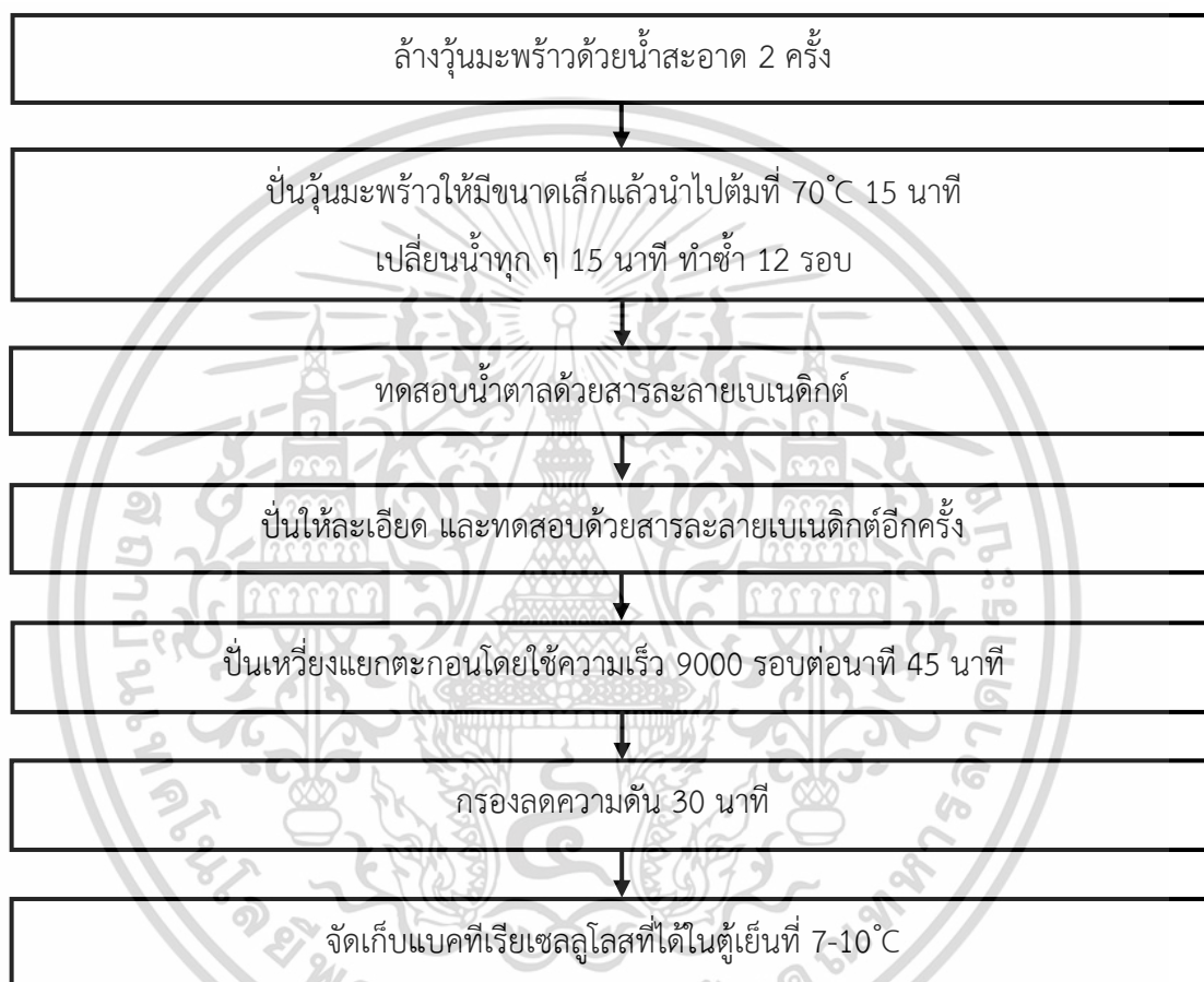
รูปที่ 3.1 แผนผังขั้นตอนการเตรียมแบคทีเรียเซลล์โลส
