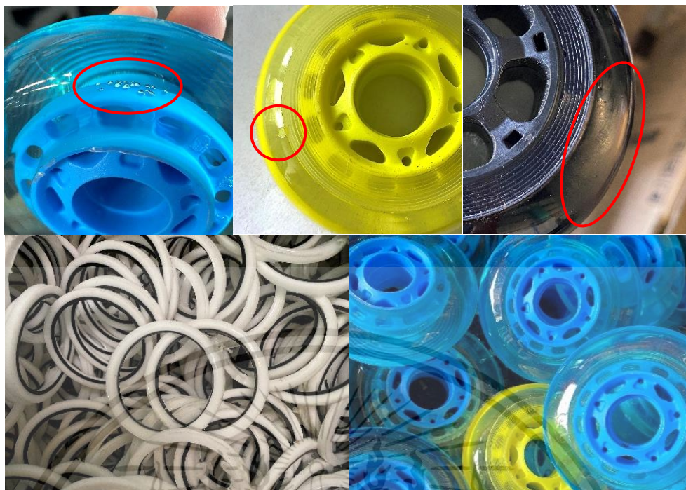
รูปที่ 1.4 ตัวอย่างจุดบกพร่องที่พบบนล้อยางพอลิยูรีเทนและเศษตัดตกแต่ง
