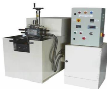
รูปที่ 2.8 เครื่องผสมแบบปิด (Internal mixer) [36]
