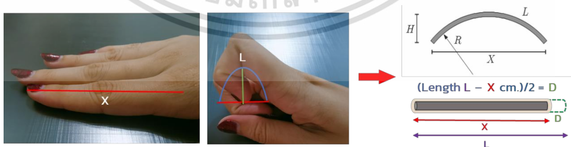
รูปที่ 3.18 แสดงวิธีการหาระยะในการดิ่งยึดตามการงอนิ้วมือ
