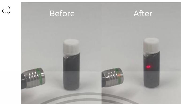
รูปที่ 4.5 แสดงการทดสอบความโปร่งแสงของวัสดุ a.) H4 b.) MH4 และ c.) MH4T3
