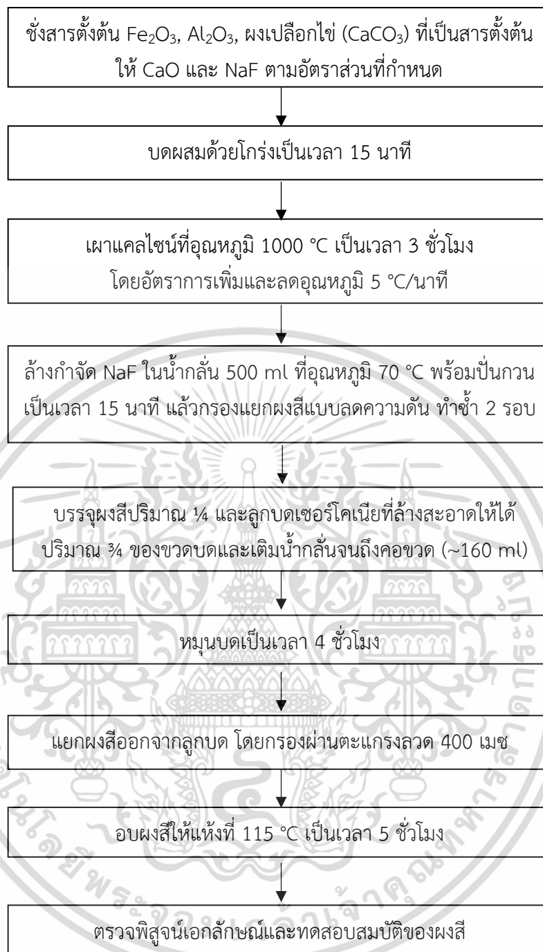
รูปที่ 3.2 แผนภาพกระบวนการสังเคราะห์ผงสีด้วยปฏิกิริยาของแข็ง
