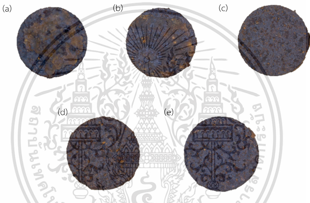
รูปที่ 4.8 ชิ้นงานโลหะที่เกิดสนิมที่ผ่านการแปลงด้วยสารแปลงสนิมกรดแทนนิกเข้มข้นร้อยละ 2 โดยน้ำหนัก โดยมีโซเดียมโดเดคซิลที่ความเข้มข้นแตกต่างกัน หลังทำการทดลองในสารละลายโซเดียมคลอไรด์เข้มข้นร้อยละ 3 โดยน้ำหนัก (a) TA2% [SDS 0] (b) TA2% [SDS 0.0013] (c) TA2% [SDS 0.0026] (d) TA2% [SDS 0.0052] (e) TA2% [SDS 0.0104]
