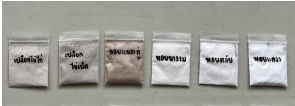
รูปที่ ก-5 หลังจากอบแห้งแล้วนำมาบดละเอียดด้วยโกร่งบดยา และแบ่งใส่ถุงซิปล็อคเพื่อส่งวิเคราะห์
