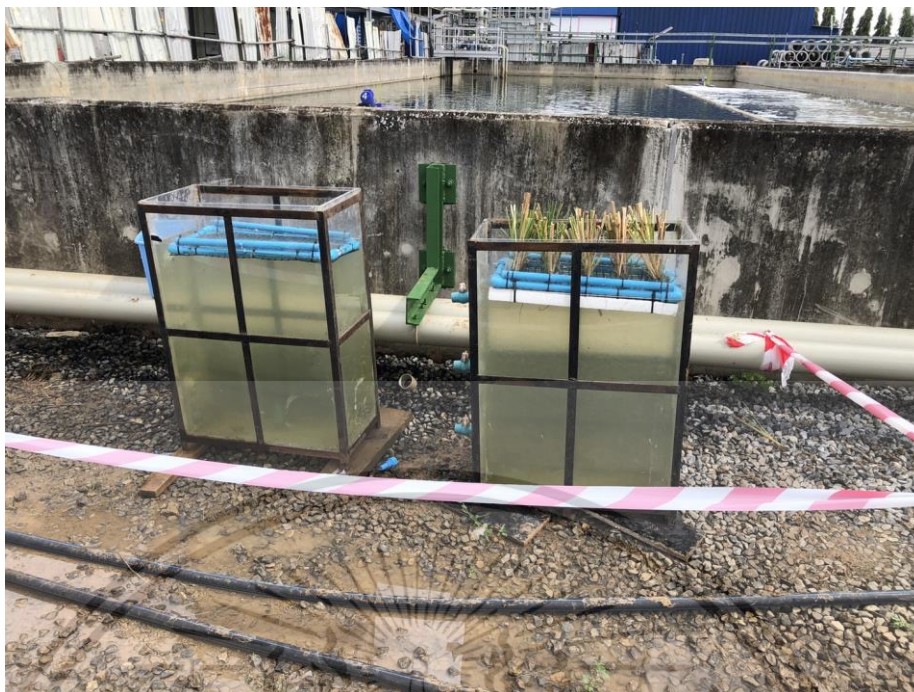
รูปที่ ง.3 บ่อทดลองและบ่อควบคุมก่อนบำบัด
