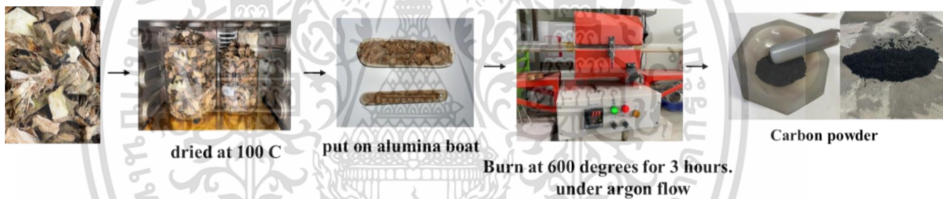
รูปที่ 3.2 การเตรียมคาร์บอนกัมมันต์จากกระบวนการคาร์บอนไนเซชัน
