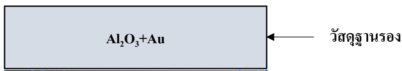
รูปที่ 5.5 ภาพตัดขวางการแพร่อะตอมทองคำลงในแผ่นผลึกอะลูมินา
