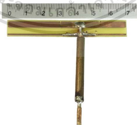
รูปที่ 4.1 ภาพถ่ายของสายอากาศแบบแพทช์แบนคู่ด้วยเทคนิคคัปปลิงความจุไฟฟ้าแบบข้อศอกคู่ต้นแบบ
