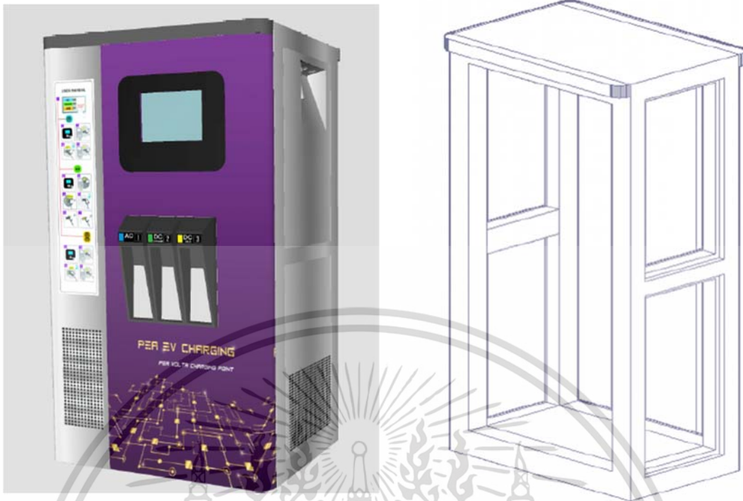
รูปที่ 4.1 การออกแบบโครงสร้างเครื่องอัดประจุแบตเตอรี่รถยนต์ไฟฟ้าแบบหลายมาตรฐาน
