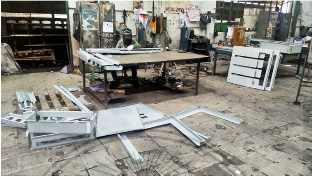
รูปที่ 4.4 การพับเหล็กแต่ละส่วนของเครื่องอัดประจุแบตเตอรี่รถยนต์ไฟฟ้า
