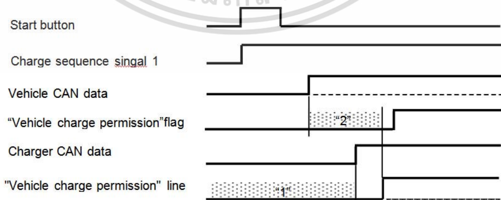
รูปที่ 3.22 สัญญาณการเชื่อมต่อโปรโตคอลระหว่างตัวรถยนต์ไฟฟ้ากับเครื่องอัดประจุ [6] เอกสารนี้เป็นเอกสารที่สงวนไว้สำหรับการใช้งานเพื่อการศึกษาเท่านั้น ไม่อนุญาตให้นำไปใช้ประโยชน์ด้านการค้า ไม่ว่ากรณีใดๆ ทั้งสิ้น อีกทั้งห้ามมิให้ดัดแปลงเนื้อหา และต้องอ้างอิงถึงเจ้าของเอกสารทุกครั้งที่มีการนำไปใช้
