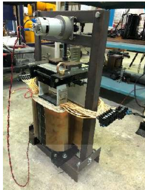
(ค) กลไกมอเตอร์ปรับค่าความเหนี่ยวนำไฟฟ้า
