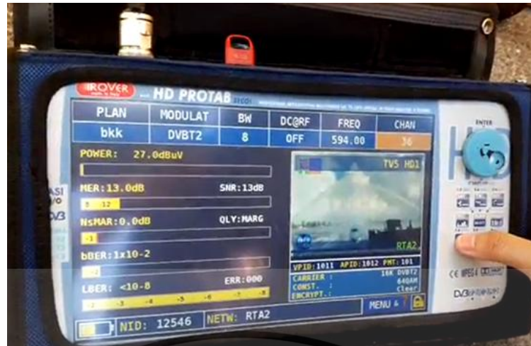
รูปที่ 4.2 การวัดความแรงของสัญญาณที่ได้รับด้วยเครื่องวิเคราะห์สเปกตรัม
