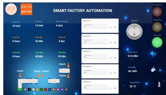
รูปที่ 35 จอแสดงผลและสั่งงานกระบวนการตัดแยกกล่องเหล็กสีต่างๆ แบบเรียลไทม์
