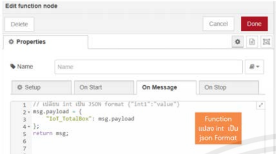
รูปที่ 16 Function node เปลี่ยนข้อมูลจาก PLC เป็น Jsn format
