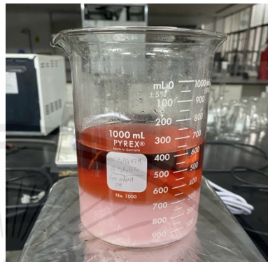
รูปที่ 3.21 การปรับ pH สารละลายในการตกตะกอนอะลูมิเนียม
