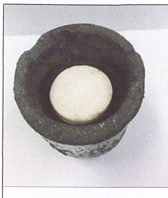
รูปที่ 3.8 ถ้วยแกรไฟต์ที่มีเม็ด Mg_2Si
