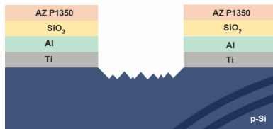
(ญ) ทำการกัดพื้นผิวซิลิคอนด้วยสารละลาย TMAH ผสมกรดซัลฟิวริก
