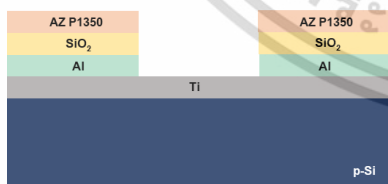
(ณ) กัดชั้นอะลูมิเนียมออกด้วยน้ำยาผสมกรดฟอสฟอริก
