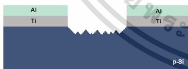
(ฑ) ลอกชั้นออกไซด์ที่เหลือออกด้วยสารละลาย BOE
