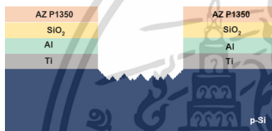
(ฎ) ทำการกัดพื้นผิวซิลิคอนด้วยสารละลายผสมกรดไนตริกและไฮโดรฟลูออริก
