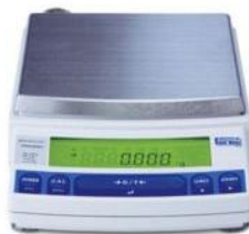
ภาพที่ 3.7 เครื่องชั่งไฟฟ้าแบบดิจิทัล 6,200 g x 0.01 ยี่ห้อ Shimadzu รุ่น Shimadzu UX6200H
