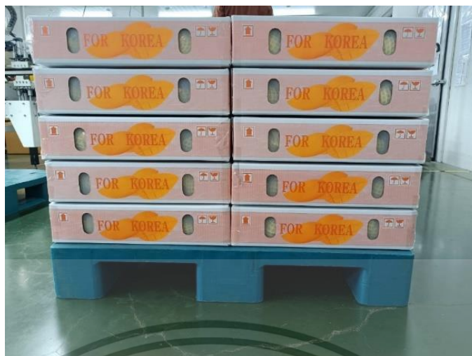
ภาพที่ 3.3 การจัดเรียงกล่องมะม่วงน้ำดอกไม้สีทองสำหรับการจำลองสภาวะการขนส่งทางอากาศใน แต่ละทรีทเม้นต์
