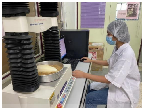
ภาพที่ 3.9 การวางมะม่วงในถาดที่มีทรายละเอียด และการตรวจวัดเนื้อสัมผัส
