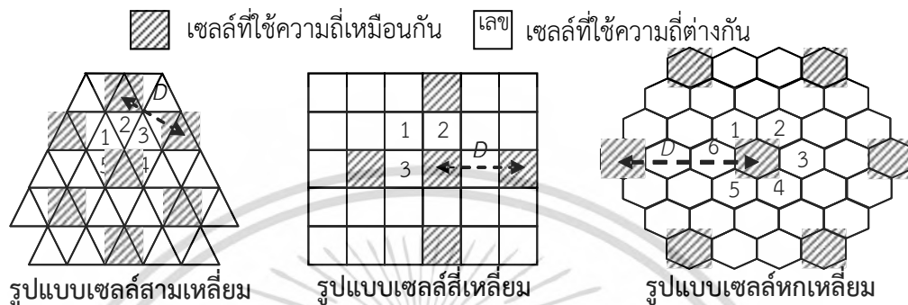
รูปที่ 2.32 การใช้ความถี่ของสัญญาณซ้ำของเซลล์รูปแบบต่างๆ
