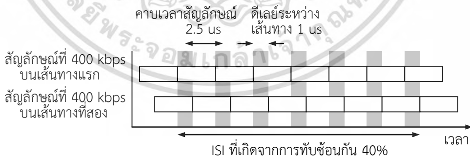
รูปที่ 2.13 การเกิด ISI ในสภาพแวดล้อมที่เกิดมัลติพาท
