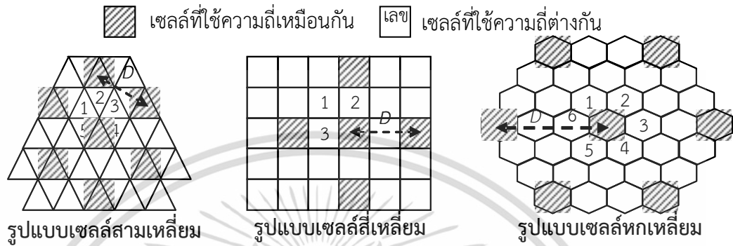
รูปที่ 2.24 การใช้ความถี่ของสัญญาณซ้ำของรูปแบบเซลล์ต่าง ๆ
