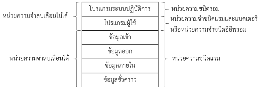
รูปที่ 2.5 หน่วยความจำของพีแอลซี
