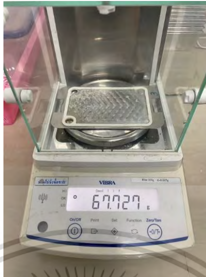
รูปที่ 3.9 การวัดมวลคราบน้ำถั่วเหลือง
