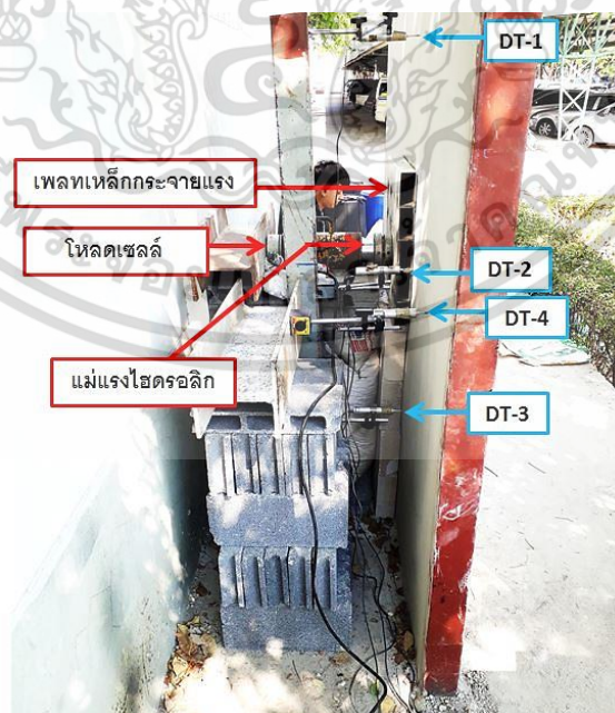
รูปที่ 3.3 ลักษณะการติดตั้งอุปกรณ์ที่ใช้ทดสอบและเครื่องมือวัด
