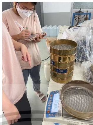
รูปที่ 3.2 ชั่งน้ำหนักของตะแกรงแต่ละเบอร์และถาดรองตะแกรง
