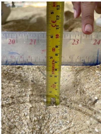
รูปที่ 4.22 การวัดค่าการทรุดตัวสุดท้ายในบริเวณที่เสริมกำลังด้วยแผ่นยางพารารมควัน
