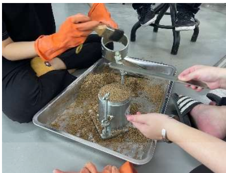
รูปที่ 3.7 การใช้เหล็กปาดดิน ปาดดินที่เกินขอบ Mold ออก
