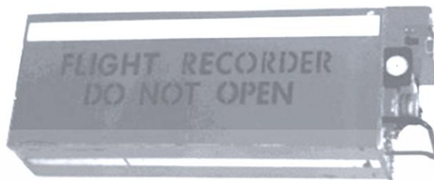
รูปที่ 2.21 เครื่องบันทึกข้อมูลการบิน (The Flight Data Recorder – FDR) [16]
