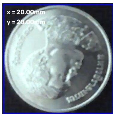
รูปที่ 4.2 แสดงการเปลี่ยนหน่วยพิกเซลที่วัดได้จากเหรียญเป็นหน่วยมิลลิเมตร
