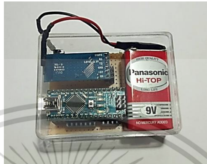
รูปที่ 3.52 กล่องควบคุมเครื่องวัดแรงกดผ่านเครือข่ายไร้สายสำหรับการเดิน
