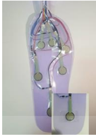
รูปที่ 3.49 แผ่นฐานพร้อมเซนเซอร์แบบสมบูรณ์
