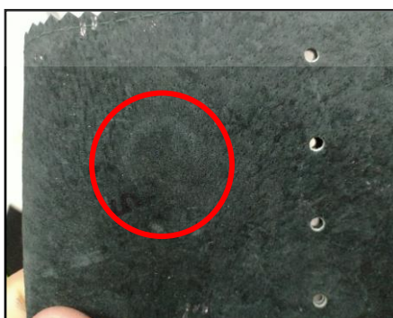
รูปที่ 3.37 เกิดการยุบตัวไม่คืนรูปหนังเทียมแบบผ้า 0.25 มิลลิเมตร หลังการทดสอบ
