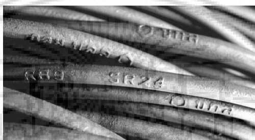
ภาพที่ 2.9 ลักษณะของเหล็กเส้นกลม SR24
