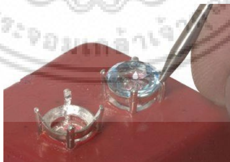
ภาพที่ 2.8 การฝังอัญมณีลงบนเครื่องประดับแบบหนามเตย
