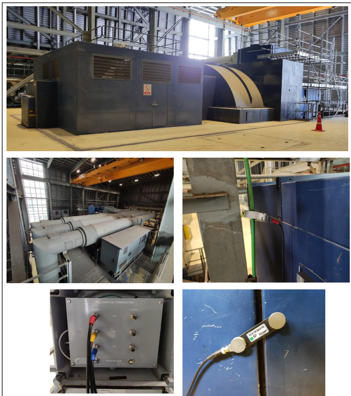
รูปที่ 4.2 รูปถ่ายการเก็บผล PD ในหน้างานจริง ของกรณีศึกษาเครื่องกำเนิดไฟฟ้า 211 MVA
