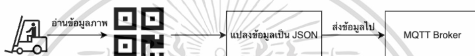
รูปที่ 3.4 ขั้นตอนการทำงานอินเทอร์เน็ตในทุกสิ่ง (Internet of Things) บนรถโฟล์คคลิฟท์
