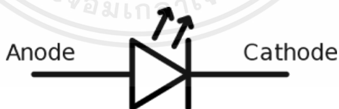
รูปที่ 2.48 สัญลักษณ์ไดโอดเปล่งแสงแอลอีดี [50]
