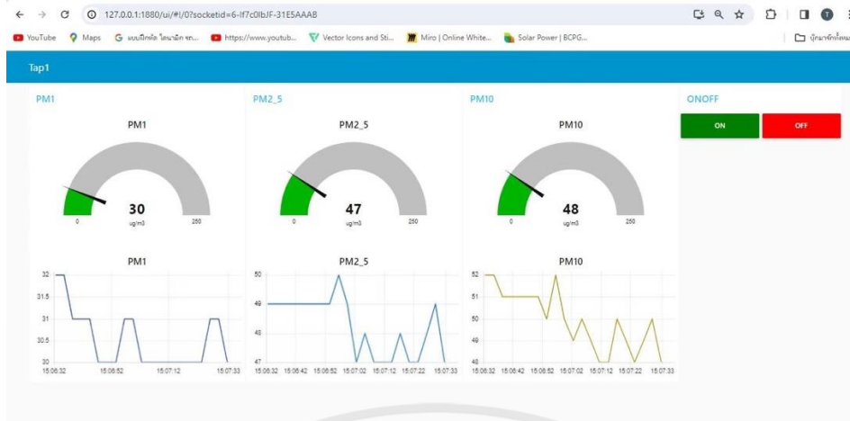
รูปที่ 3.6 หน้าเว็บแอปพลิเคชันแสดงค่าฝุ่นและปุ่มควบคุมการเปิด-ปิดวงจร
