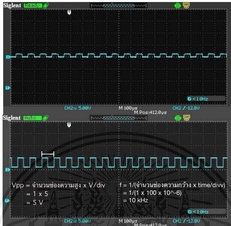
รูปที่ 4.11 สัญญาณขาเข้าและขาออกของอุปกรณ์ H11L1
