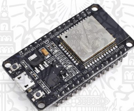
รูปที่ 2.28 บอร์ดไมโครคอนโทรลเลอร์ ESP32 WROOM-32 [26]
