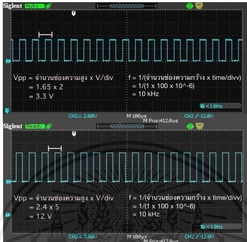
รูปที่ 4.10 สัญญาณขาเข้าและขาออกของอุปกรณ์ LF351
