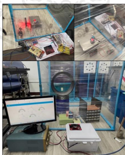
รูปที่ 4.24 ห้องจำลองจะมีเครื่องวัดฝุ่นที่มีมาตรฐานกับเครื่องวัดฝุ่นที่ใช้เซนเซอร์วัด
