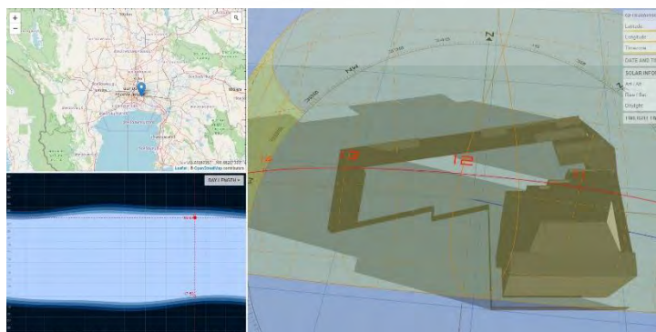
รูปที่ จ.15 การเกิดเงาในวันที่ 15 เดือนตุลาคม เวลา 6.30 น. สำหรับทางเลือก A
