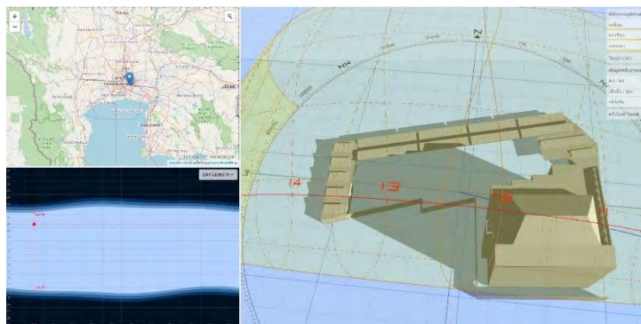
รูปที่ จ.60 การเกิดเงาในวันที่ 15 เดือนกุมภาพันธ์ เวลา 8.30 น. สำหรับทางเลือก D
