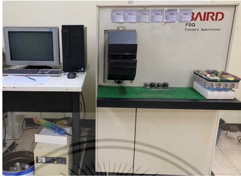
รูปที่ 3.2 เครื่องสเปกโตรมิเตอร์ (Spectrometer) ยี่ห้อ Baird รุ่น FSQ S/N 2712A
