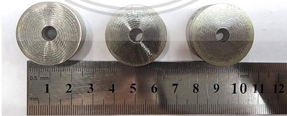
รูปที่ 3.22 ชิ้นงานเหล็กกล้าผสมแมงกานีสก่อนการทดสอบของ 11Mn 18Mn และ 21Mn เอกสารนี้เป็นเอกสารที่สงวนลิขสิทธิ์ไว้เพื่อการศึกษาเท่านั้น เมื่ออนุญาตให้เผยแพร่ไปยังผู้อื่นโดยไม่ได้รับอนุญาต ไม่ว่ากรณีใดๆ ทั้งสิ้น อีกทั้งห้ามมิให้ดัดแปลงเนื้อหา และต้องอ้างอิงถึงเจ้าของเอกสารทุกครั้งที่มีการนำไปใช้
