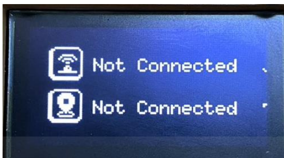
รูปที่ 4.77 แสดงสถานการณ์เชื่อมต่อบน OLED Module กรณีที่ยังไม่ถูกเชื่อมต่อ
