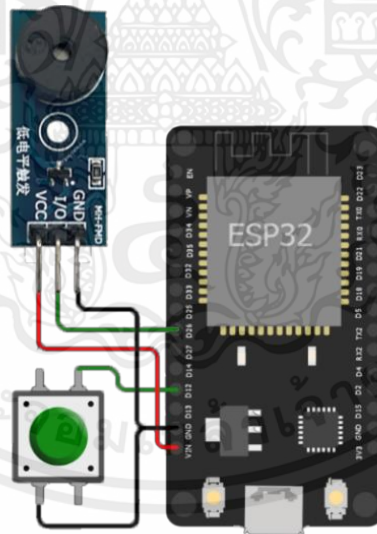
รูปที่ 3.13 การออกแบบการทดสอบการทำงานของ Buzzer Module
