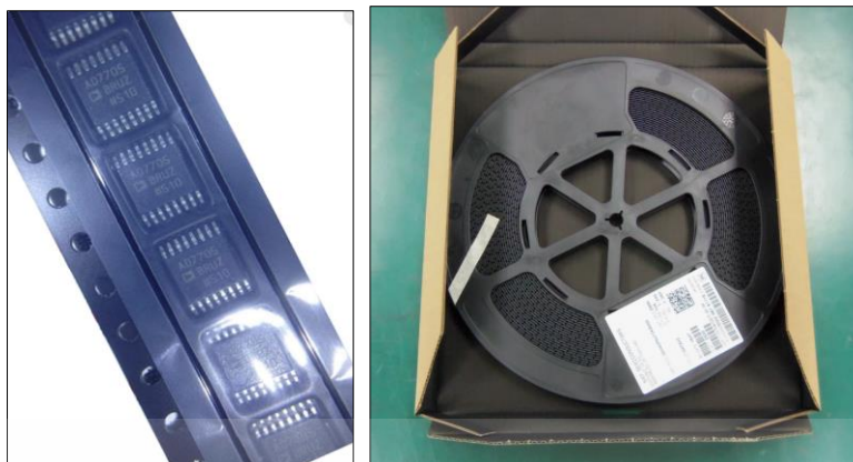
รูปที่ 2.15 ลักษณะการบรรจุภัณฑ์วงจรรวมลงใน Carrier tape และ Reel
