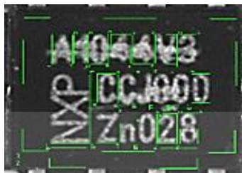
รูปที่ 3.13 ตัวอย่างผลิตภัณฑ์ที่ควรถูกปฏิเสธแต่กลับถูกยอมรับแบบ Marking
